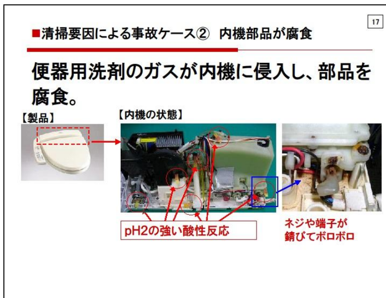
【清掃時に洗剤のガスが発生して、機械内部を通過して部品を腐食させた状態の写真】 提供：一般社団法人温水洗浄便座工業会（講師使用の説明資料より、承諾を得て転記しています）
